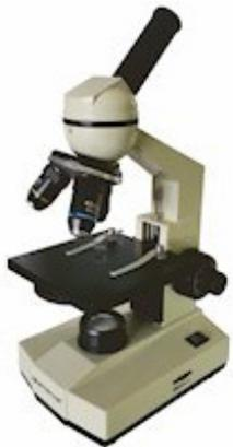
Microscopio monocolare inclinazione 45°, rotazione 360°. Revolver: Triplo. Campo di Osservazione dell'oculare: WF10X. Obiettivo: Acromatico DIN 4X, 10X, 40X(S). Tavolo portapreparati: 125x115/70x20 mm con piano traslatore incorporato. Condensatore: Abbe A.N.=1.2 con Diaframma a Iride e Filtro Blu. Range di Messa a Fuoco Macro - Micro (10mm). Illuminazione: Lampada ad Incandescenza 230V/20W, con luminosità regolabile.
